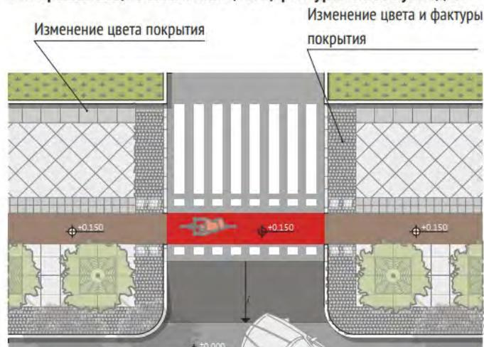
**Схема 3. Наземный пешеходный переход. Ширина пешеходного тротуара – более 3,0 м. Размещение тактильных указателей**
