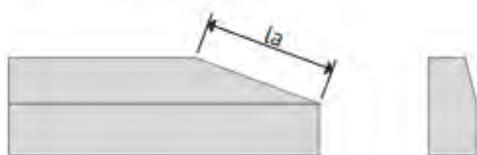
Длину аппарели (la) при тротуарных покрытиях из сборных плит принимают кратной размеру плит, а другие размеры — в зависимости от марки камня.
