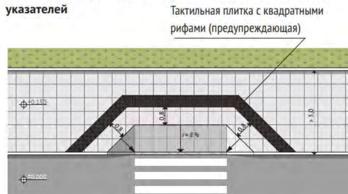
Схема 3–1. Пример организации предупреждающих покрытий при помощи изменения цвета, фактуры и типа укладки
