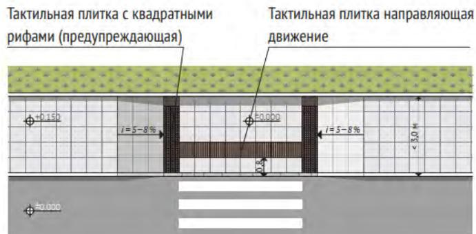
Схема 4–1. Пример организации предупреждающих покрытий при помощи изменения цвета, фактуры и типа укладки
